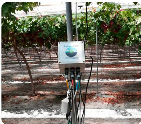
Equipo de monitoreo de estado hídrico de suelo instalado en una parcela de uva de mesa.
